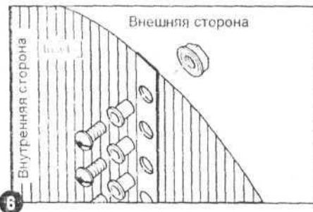
**г.** Крепко затяните винты и гайки.
