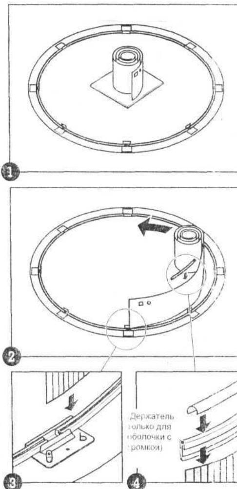
**д.** Продолжайте разматывать стенку по периметру фундамента, пока вся она не встанет в паз направляющей, а ее верхний край не будет покрыт отрезками трубы, скрепленными соединителями (и держателями оболочки, если она у вас имеет промежутки).
