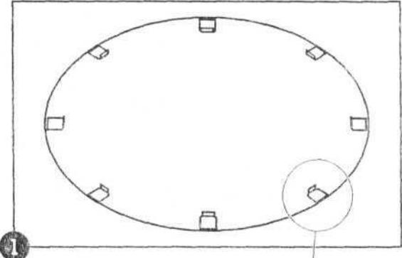
б. Вставьте загнутые рейки нижних направляющих в кронштейны основания каркаса и сдвиньте. Между концами соседних реек необходимо оставить зазор шириной  $\frac{1}{2}$ " (13 мм).
